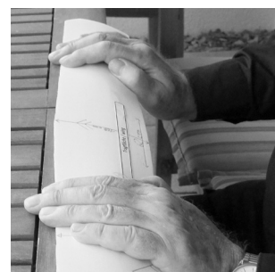
Biegen Sie die Tragfläche unter Druck über eine Tischkante.
