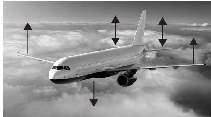
Änderungen der Auftriebskräfte an den Ruderflächen steuern ein Flugzeug.
