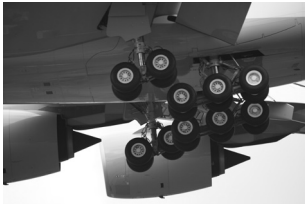
Große Passagierflugzeuge haben Fahrwerke, die eingezogen und ausgefahren werden, um den Luftwiderstand im Flug zu verringern.
