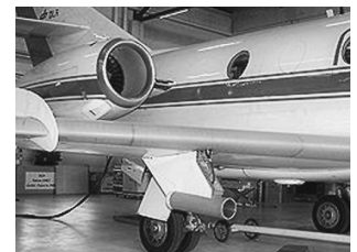
DLR-Forschungsflugzeug mit Partikelsonde am Tragflügel
