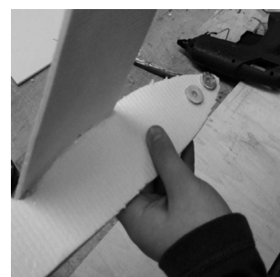
Auf die Rumpfspitze werden zwei bis vier Unterlegscheiben geklebt.
