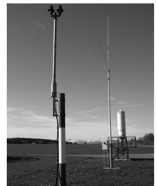
DME-Antenne (vorne, der rot-weiß markierte Pfosten ist nur der Träger der Antenne), eine NDB-Antenne (Mitte) und eine TACAN-Antenne (hinten).
